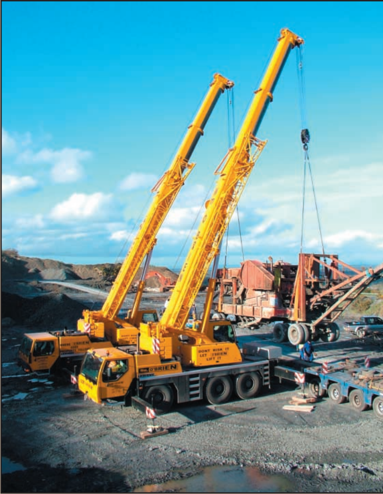
80 ton Demag All Terrain
