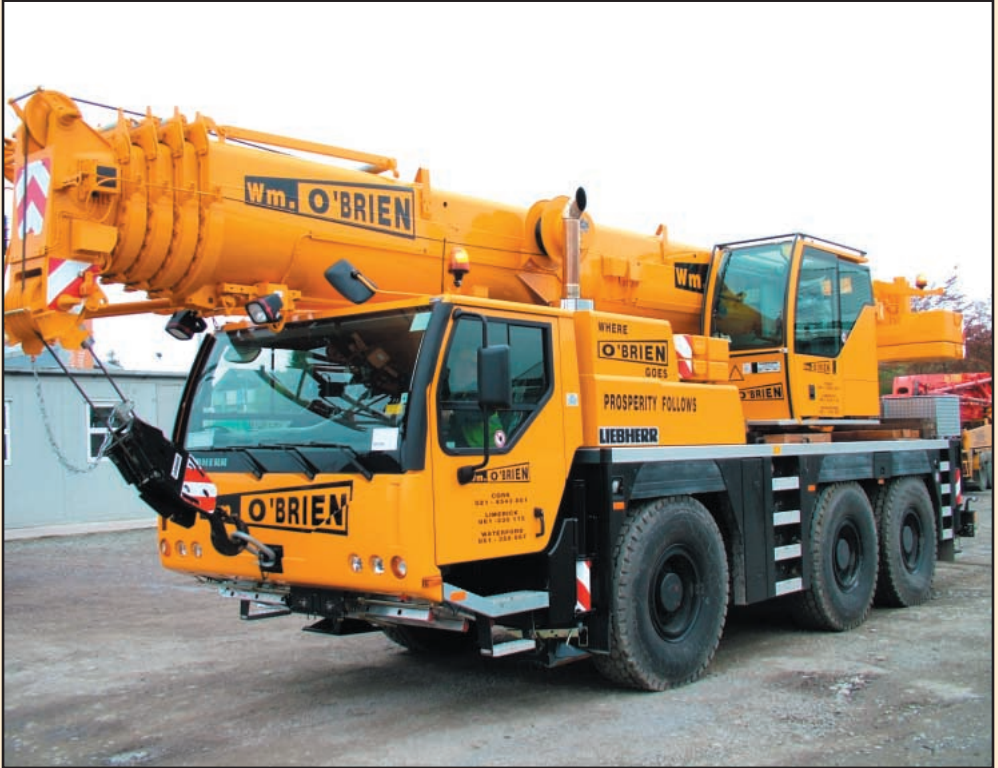
60 Ton All-Terrain Crane
