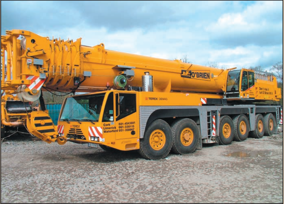
350 Ton All-Terrain Crane
