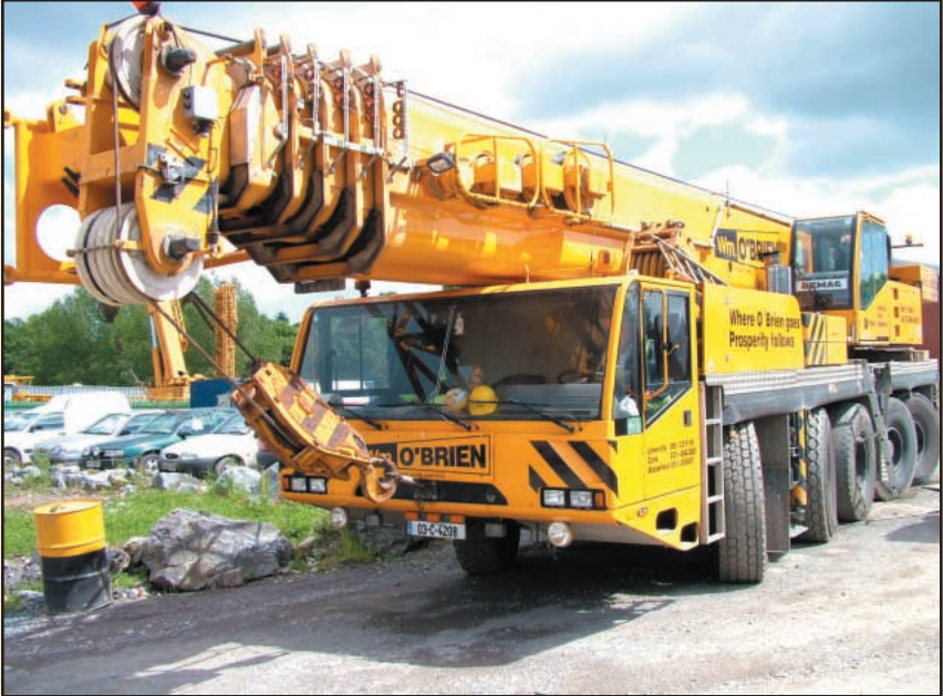
140 Ton All-Terrain Crane
